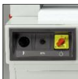
Włącznik główny i oburęczne uruchamianie cięcia
