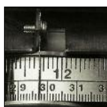
Odległość siodła od linii cięcia odczytujesz w okienku z taśmą mierniczą, w centymetrach lub calach
