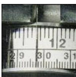
Odległość siedła od linii cięcia odczytujesz w okienku z taśmą mierniczą, w centymetrach lub calach
